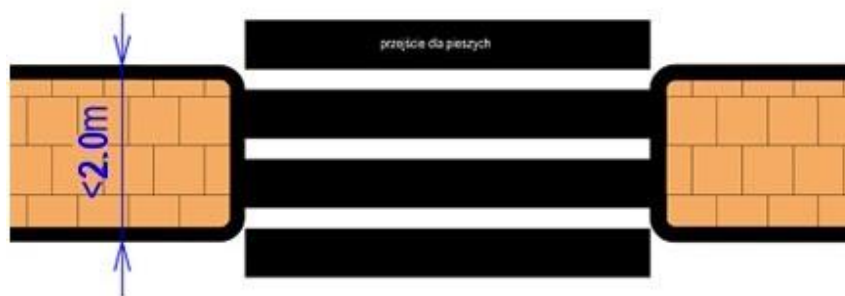
Rys. .15. Przykład rozwiązania przejścia dla pieszych przecinającego pas dzielący szerokości < 2,0 m. (rysunek nie przedstawia sposobu układania płyt)
