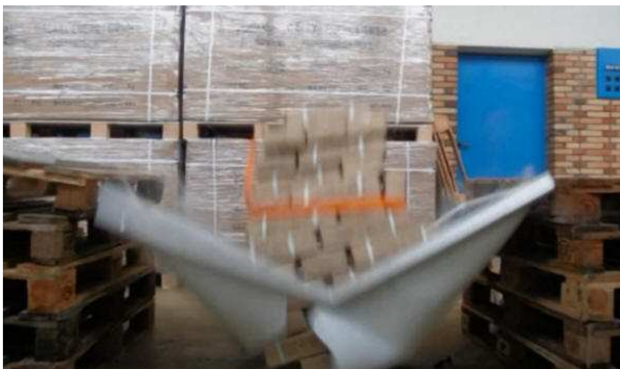
Fot. Pokaz wytrzymałości panelu PV.
