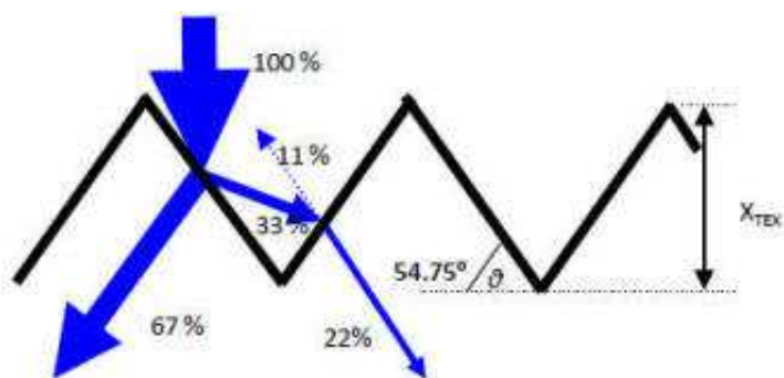
Rys. Piramidy po teksturyzacji alkalicznej
